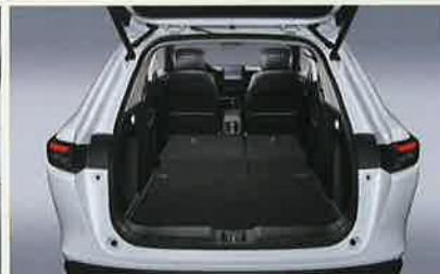
Utility Mode 彈性 U 模式 後座椅背可完全向前打平 與行李廂結合成格局方正且平整的超大置物空間
